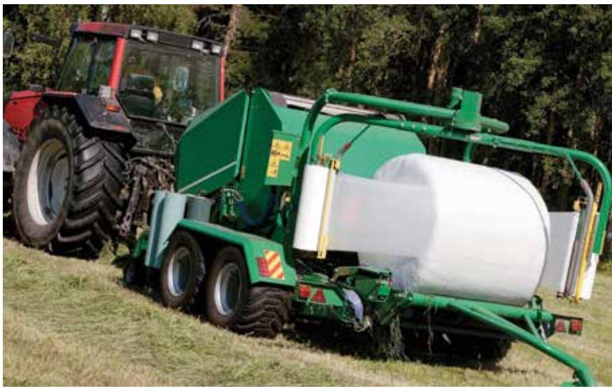
Streč folije za silažu koriste se u poljoprivredi i stočarstvu. Namenjene su za mašinsko obavijanje bala pokošene trave i spremanje silaže, čime se čuva izvrsno stanje zapakovanog sadržaja, te se olakšavaju manipulacija i transport silažne stočne hrane.
