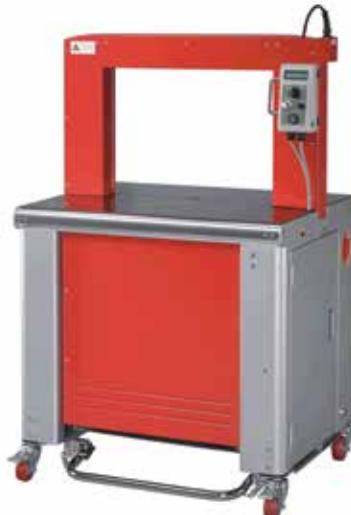
TP - 702-59 je poluautomatska mašina za vezivanje PP trakom u standardnoj verziji. Start maštine je moguć preko nožne poluge s prednje strane, ručnim tasterom (standardne opcije). Elektronsko kontrolisanje zatezanja, automatsko uvlačenje trake i automatsko izbacivanje vezova na prazno.
